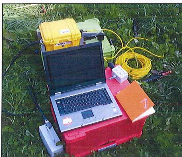
Figura 2: Strumentazione utilizzata per la prova MASW.
